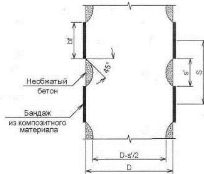
Рис. 6.2.4. Усиление колонны отдельными бандажами по высоте.
